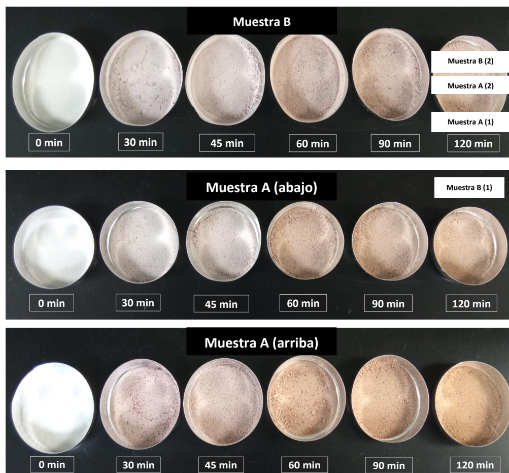
Figura 10. Apariencia de las muestras de PVC sometidas a temperatura de 177°C obtenidas empleando el agente de parada corta de "A" y "B".
